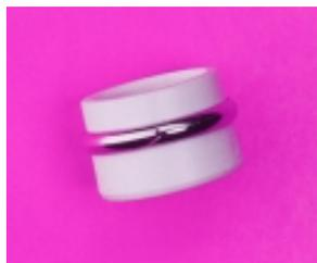
Предназначен для натягивания замши или бумаги при испытании остроты медицинских инструментов. Корпус барабанчика изготовлен из полистирола, кольцо - из латуни с защитным покрытием.
